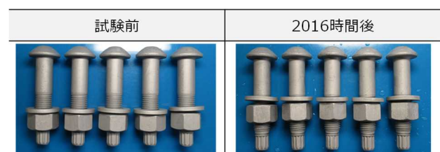
図-2 耐塩水噴霧性試験結果
