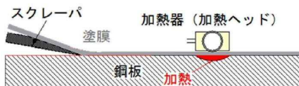
図-1 IH塗膜除去工法の塗膜剥離イメージ
