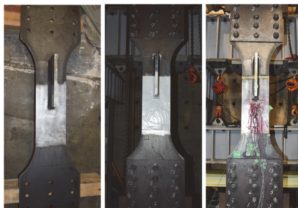
(a) 下地処理 (b) 塗装後の状況 (c) セットアップ 図-2 試験体の塗装工程とセットアップ状況
