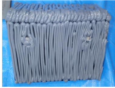
(e) CFRP板への塗布の状況
