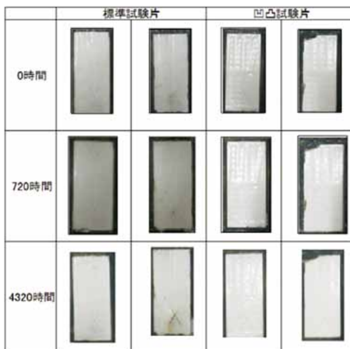
写真-3 試験片外観状況 (抜粋) F'無溶剤型エポキシ樹脂系 (塗料改良版)
