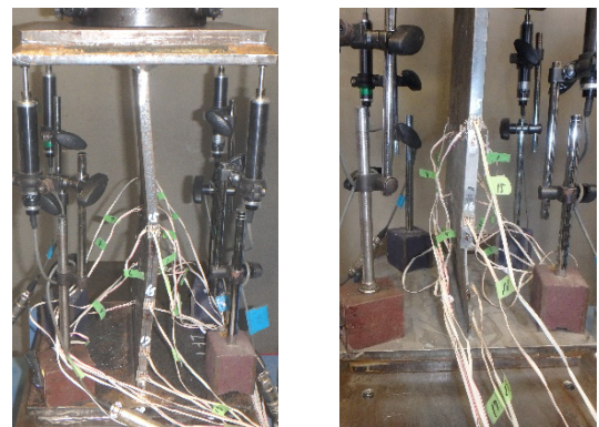
a) 健全 b) 腐食・無補強 図-6 破壊形態
