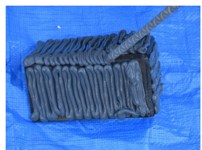
(i) CFRP板への塗布の状況
