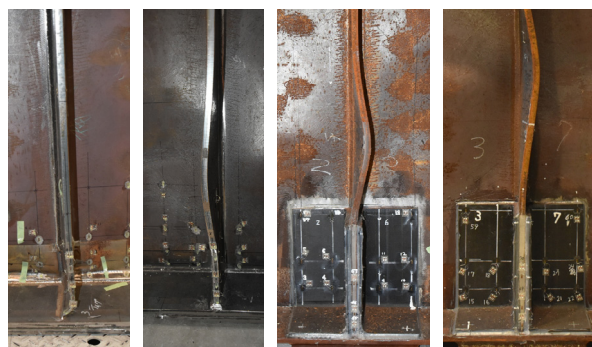
(a) 無補修 (b) 健全 (c) 補修不良なし (d) 補修不良あり
