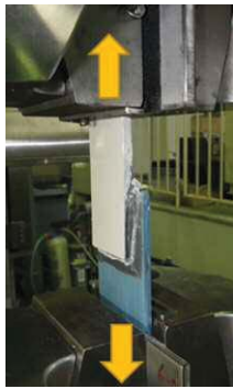
図-5 引張せん断試験
